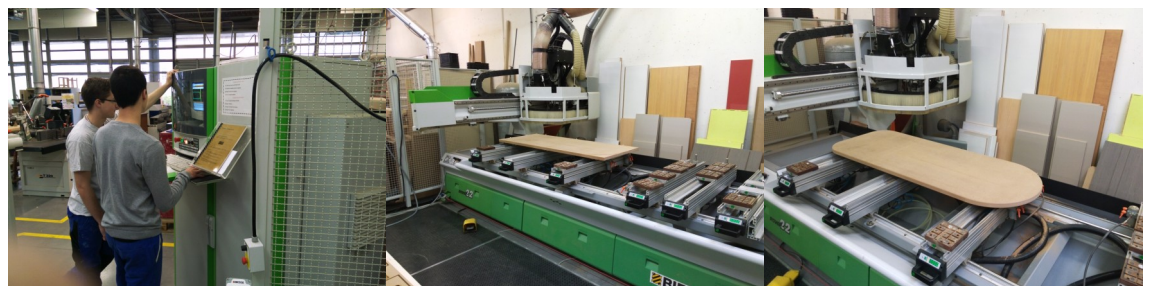
De la programmation du centre d'usinage à la réalisation des pièces du bureau
